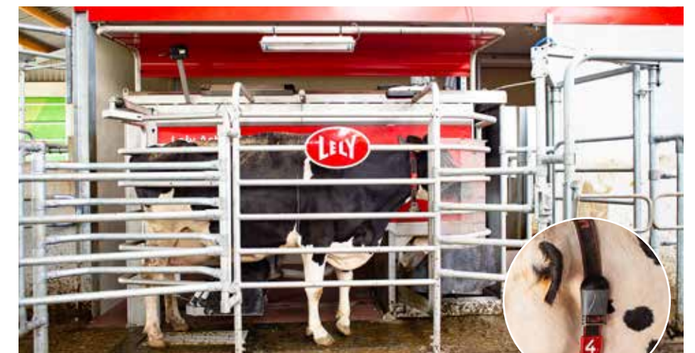
De koe kiest zelf wanneer ze aan de melkrobot gaat staan. De transponder aan haar hals houdt de rusttijden tussen melkbeurten bij.
